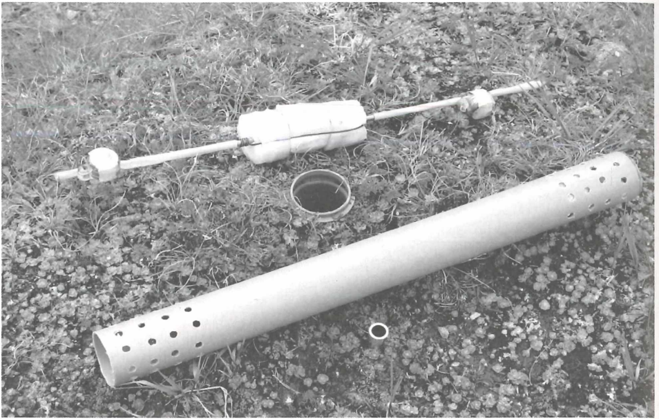
Abb. 4: Montage der Tidbit-Datenlogger (Onset Computer Corporation, Pocasset, USA) in 10 und 50 cm Bodentiefe. Die Logger wurden in perforierten PVC-Rohren versenkt und am höchsten Punkt des Bults bzw. am tiefsten Punkt der Senke eingegraben.
